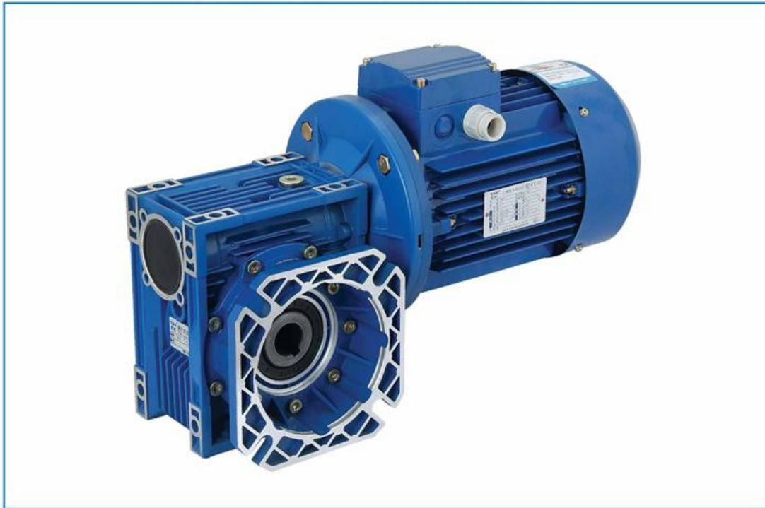
基本型NMRW减速机的动力运动由蜗杆输入，经过减速后由蜗轮轴孔输出运动。减速机的输入法兰可与电机的接口法兰匹配。机箱上可配置输出法兰，用于减速机的固定联接。蜗杆和蜗轮的传动中心距（mm）即为表征减速机的机座规格。
